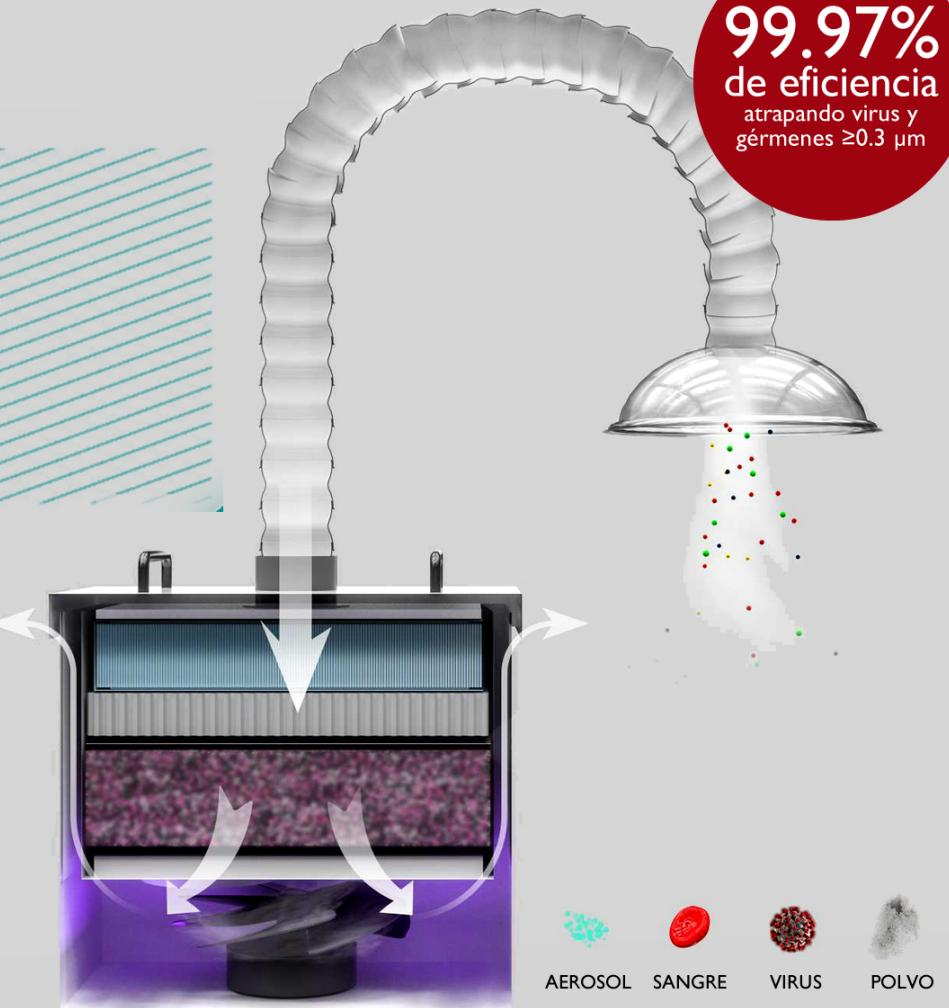
VacStation es un extractor de aerosoles extraoral para prevención de la contaminación cruzada en tratamientos dentales que involucren generación de aerosoles, como destarajes, operatoria, etc.
