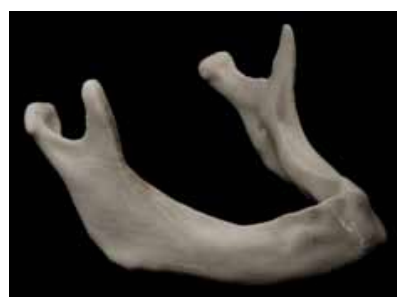
Figura 4. Previsualización del modelo tridimensional e impresión. MakerBot desktop muestra cómo será impreso el modelo, incluyendo los soportes que sostienen partes de la estructura (A). Aspecto del biomodelo tridimensional manufacturado luego de remover los soportes (B).
